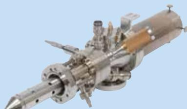
加速电压最大20kV的C<sub>60</sub>离子的离子枪。通过脉冲式照射获得二次离子。另外，可以进行样品破坏低的C<sub>60</sub>溅射。利用可调节的光栅，轻松地更改束斑大小和束流。
