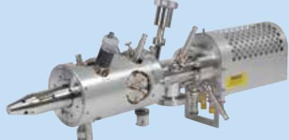
加速电压最大10kV Cs离子的溅射专用离子枪。利用可调节的光栅，轻松地更改束斑大小和束流。可实现Cs的离子检测增强效应和复合离子的检测、及大电流离子束的高速溅射。
