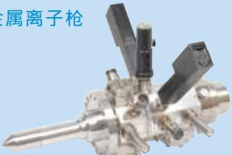
加速电压最大30kV液态金属离子的离子枪。通过脉冲式辐照取得光谱。小的束斑直径（最小80nm），在SIMS测量微小区域时很有效的。利用可调节的光栅，能涵盖由高空间分辨率到大电流的高灵敏度检测。
