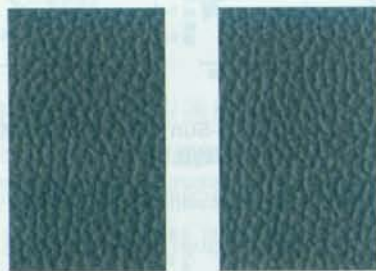
▲ 图6 用水性聚氨酯处理剂处理过的聚氯乙烯人造革氙灯试验前后对比
