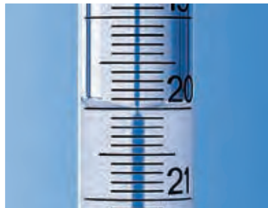
SILBERBRAND Schellbach Stripe 标记条 主刻度为短刻度。读取标记条的接触点。
