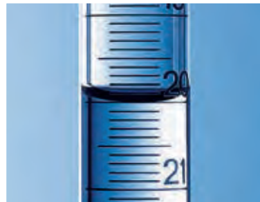
SILBERBRAND 主刻度为短刻度。 读取标凹液面的最低点。
