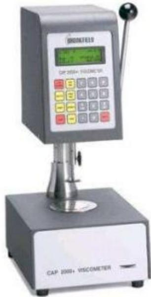
常见的旋转式粘度计是锥板式粘度计。它主要包括一块平板和一块锥板。电动机经变速齿轮带动平板恒速旋转，依靠毛细管作用使被测样品保持在两板之间，并借样品分子间的摩擦力而带动锥板旋转。在扭矩检测器内的扭簧的作用下，锥板旋转一定角度后不再转动。此时，扭簧所施加的扭矩与被测样品的分子内部摩擦力(即粘度)有关：样品粘度越大，扭矩越大。扭矩检测器内设有一个可变电容器，其动片随着锥板转动，从而改变本身的电容数值。这一电容变化反映出的扭簧扭矩即为被测样品的粘度，由仪表显示出来。
