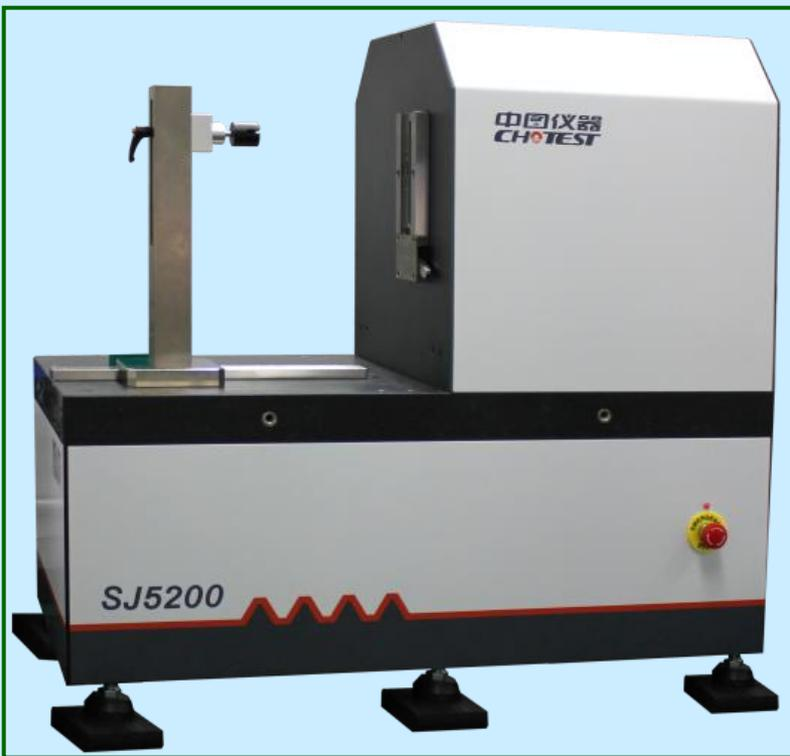
螺纹中径测量精度
