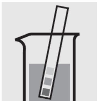
确认水样的pH在3-6之间。否则可以使用氨水或硝酸进行调节。
