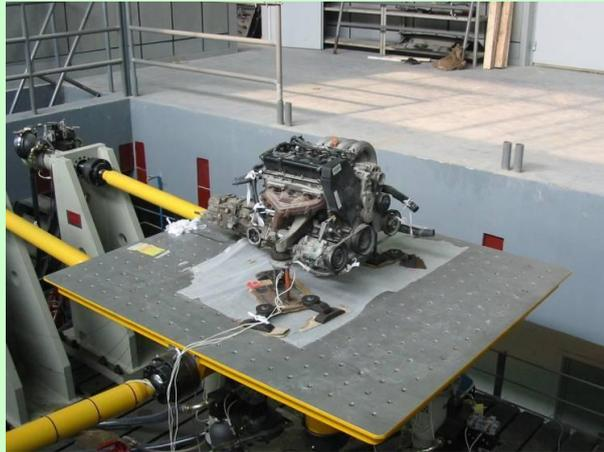
图 1 六通道振动试验台
