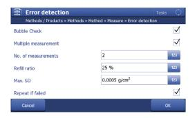
利用可靠介质进行 2 次测量,与进行一次测量所用时间基本相同,在确保最大测量可靠性的同时提供更优的数据质量!
