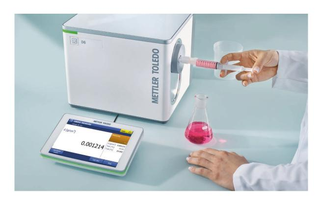
您知道吗? 样品中一个直径为 1 mm 的气泡可能会对密度测量结果带来 0.000052 g/cm³ 的误差。0.01 °C 的温度变化可能会对密度的测量带来 0.00011 g/cm³ 的误差。现代化的数字仪器非常易于使用,能够以很高的准确度测定液体的密度 – 然而,高分辨率的仪器并不能保证准确的结果。
